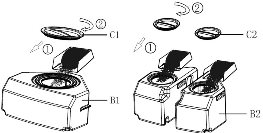
Die gefüllten Tanks mit den Schraubdeckeln verschließen.
